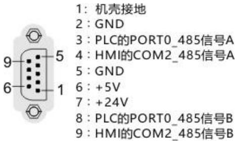
左侧PLC扩展模块接口：仅支持连接工贝经济型Smart模块
