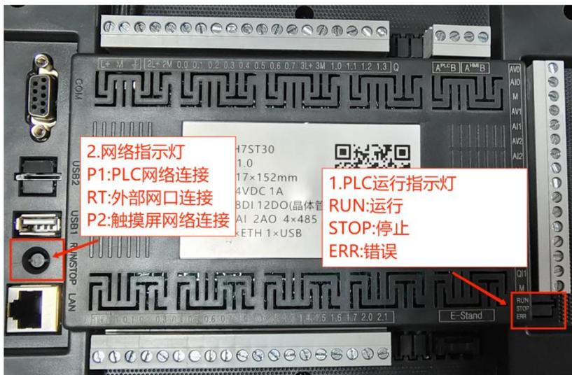
2.H10Sxxx 系列一体机背面左测散热孔内部可观察到 PLC 指示灯, 如下图注释 1。左下角散热孔内可观察到网络指示灯, 如下图注释 2。
